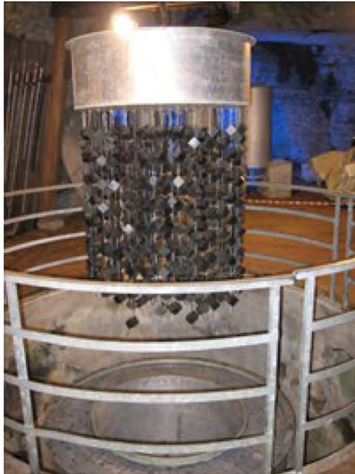
modello dell'ultimo reattore sperimentale di Heisenberg (Haigerloch Marzo 1945) con i cubetti di uranio prima di essere immersi in acqua pesante
